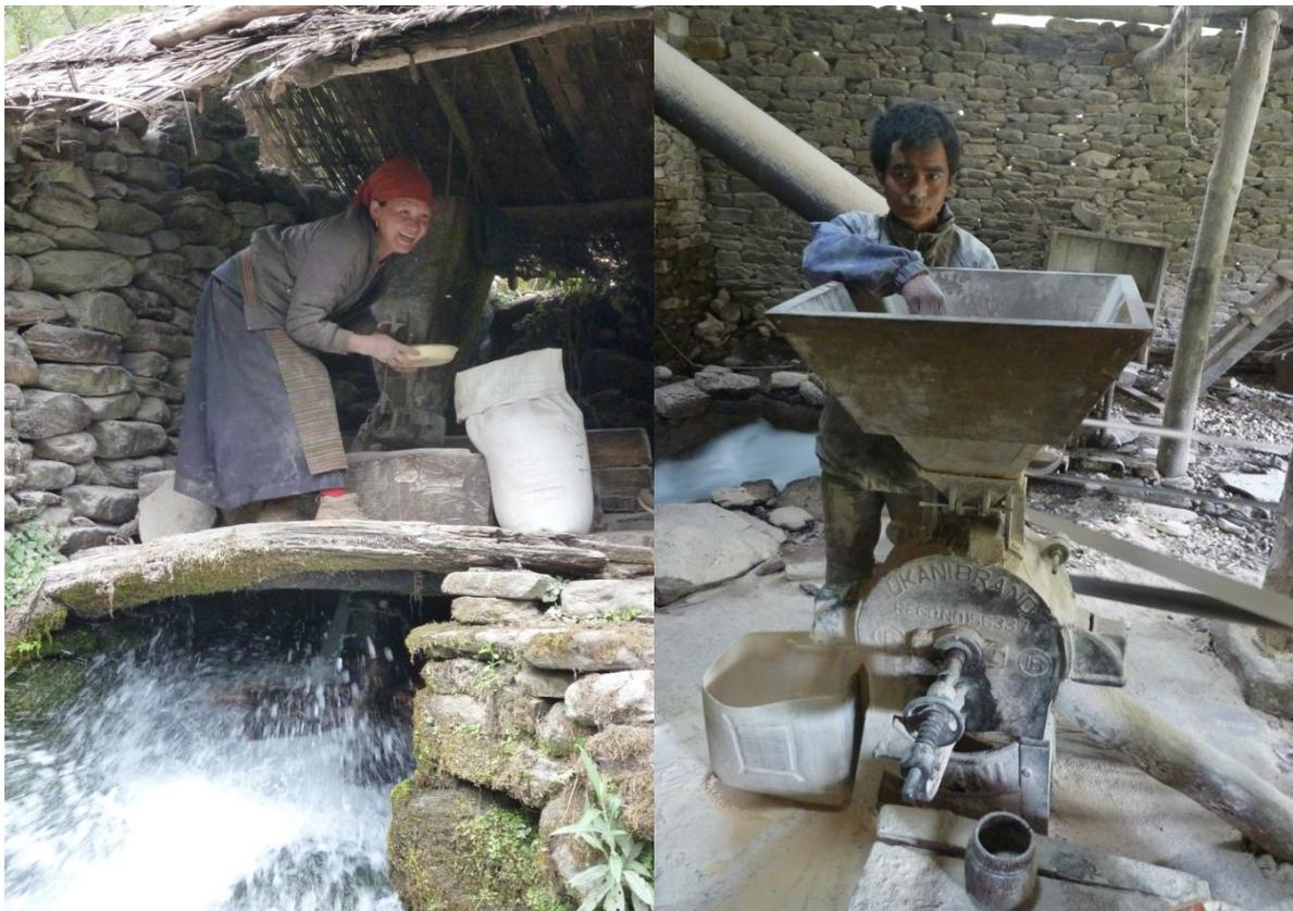
Photo 15 : A gauche, une femme sherpa récupère sa farine au moulin à eau. A droite, le meunier s'occupe d'une petite machine de minoterie utilisant l'énergie mécanique fournie par la conduite forcée.
